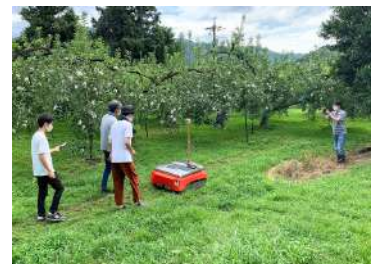
りんご園での自動草刈りロボットの試験的な実証実験
